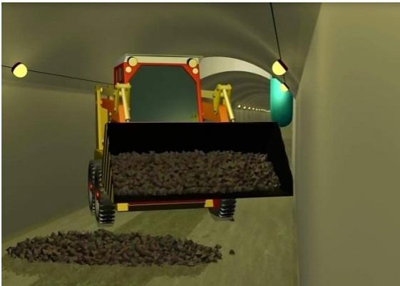
Рис. 2. Моделирование доставки дренажного материала
