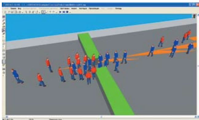
Рис. 5. Прохождение дверного проема в коридоре двумя встречными потоками пешеходов. Модель программного комплекса PTV Vision VISSIM
