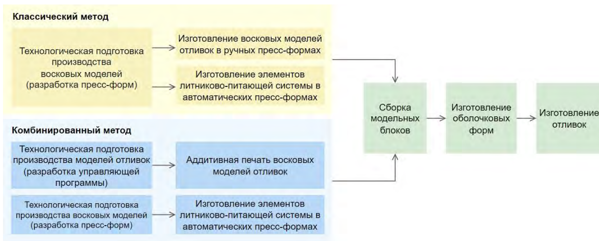
Рис. 1. Основные этапы процесса литья по выплавляемым моделям
