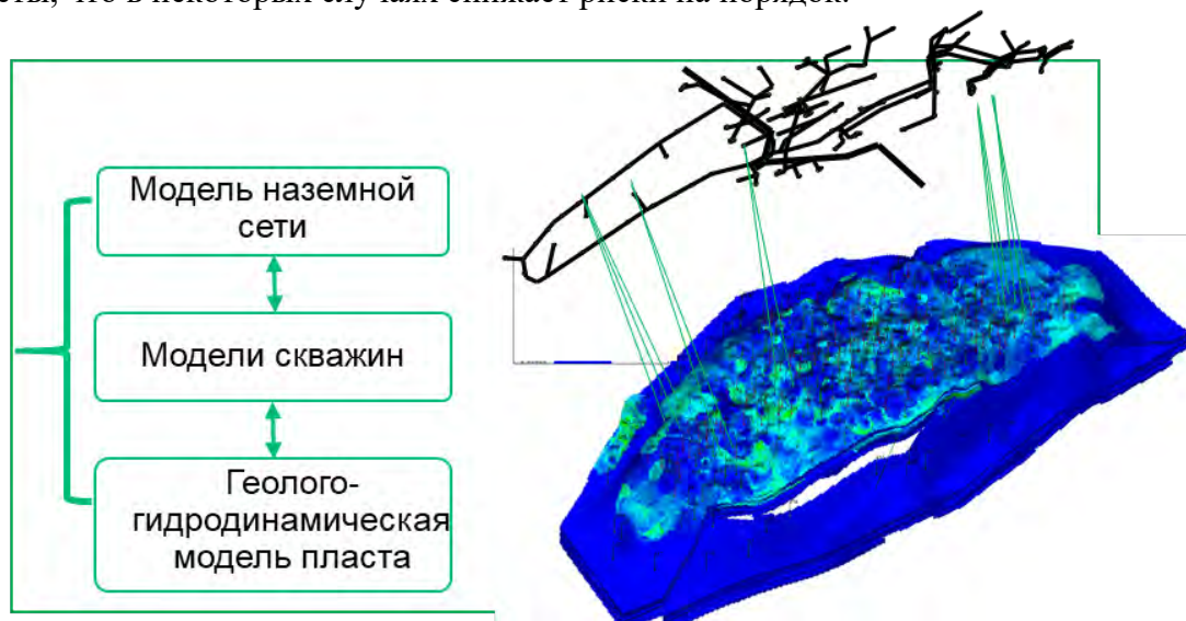
Рис. 9. Принципиальная схема взаимодействия моделей наземных сетей, моделей скважин и моделей пласта в рамках интегрированного моделирования
