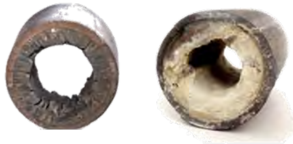
Рис. 8. Иллюстрация отложений на внутренних стенках труб систем сбора (слева) и нагнетания агента (справа).
