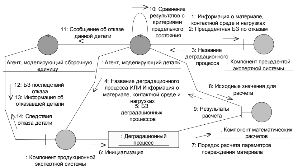
Рис. 3. Схема работы агента, моделирующего поведение детали
