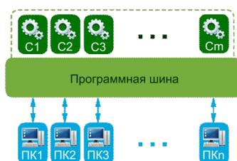
Рис. 1. Структура сервис-ориентированной среды моделирования
