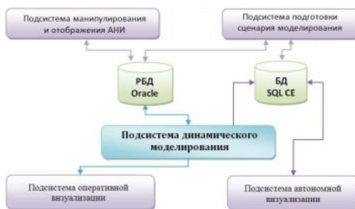
Рис. 1. Структурная схема исследовательского комплекса (АНИ – аэронавигационная информация, РБД – распределенная база данных)
