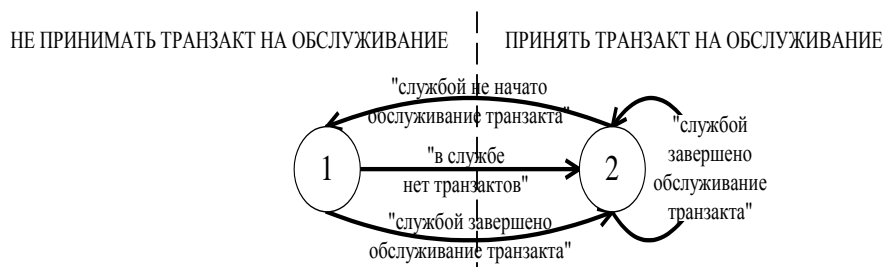
Рис. 4. Граф переходов состояний одномерного автоматного алгоритма случайного поиска с глубиной памяти «один»
