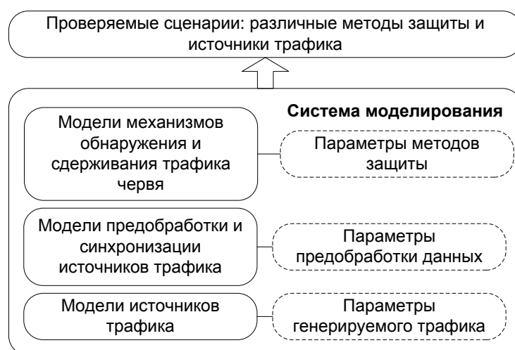
Обобщенная архитектура средств моделирования механизмов обнаружения и сдерживания сетевых червей
