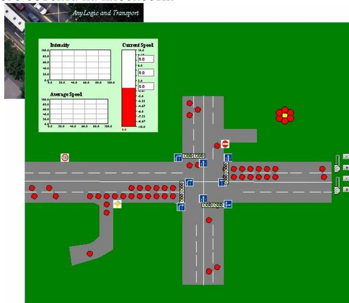
Рис. 4. Модель транспортного узла, реализованного в пакете AnyLogic на базе разработанной библиотеки классов
