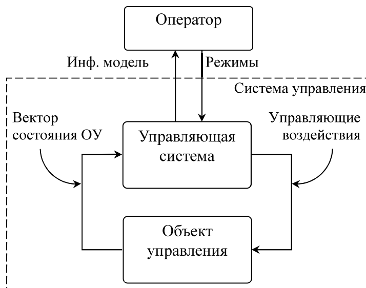
Рис. 1. Обобщённая структура человеко-машинной системы управления
