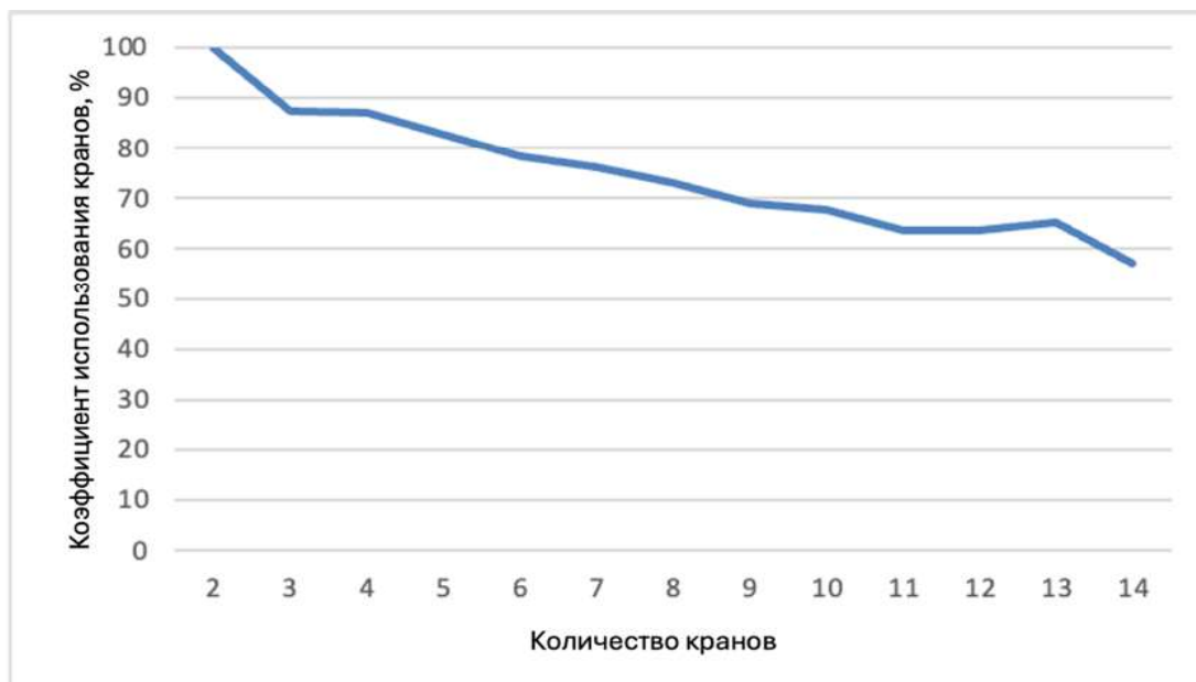
Рис. 10. Пример изменения коэффициента использования портовых кранов в зависимости от количества кранов
