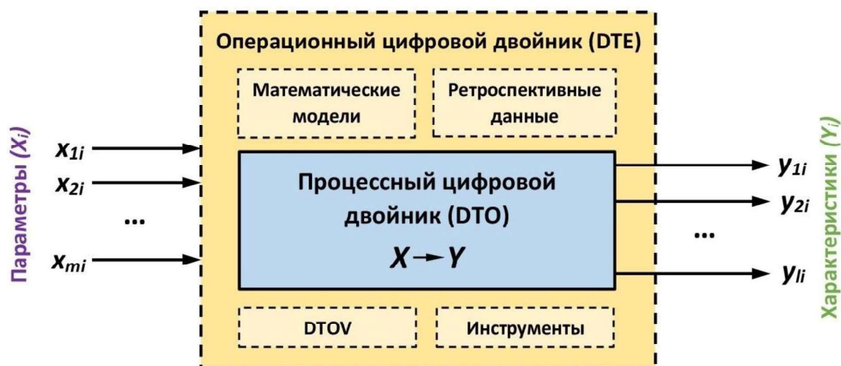
Рис. 3. Процессный эксплуатационный цифровой двойник судна
