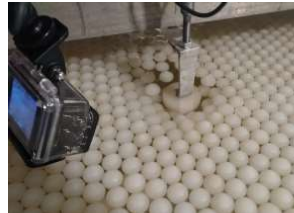
Типичный вид диаграммы разрушения однослойного композитного льда из шаровых гранул диаметром 20 мм
