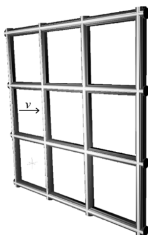
Рис. 5. Компьютерное моделирование сетчатой конструкции с некрученными элементами (сетка 9 ячеек, шаг ячеек 24,8 мм), вектор скорости потока расположен под углом 90°
