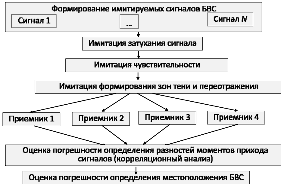
Рис. 3. Структурная схема системы определения местоположения БВС
