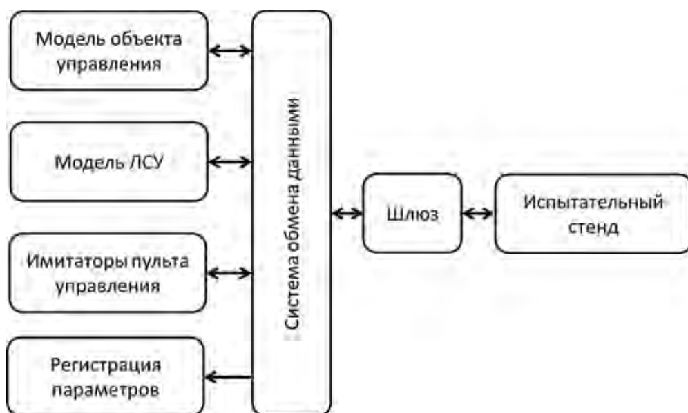
Рис. 2 – Структурная схема ПАК, предназначенного для обеспечения стендовых испытаний КСУ ТС
