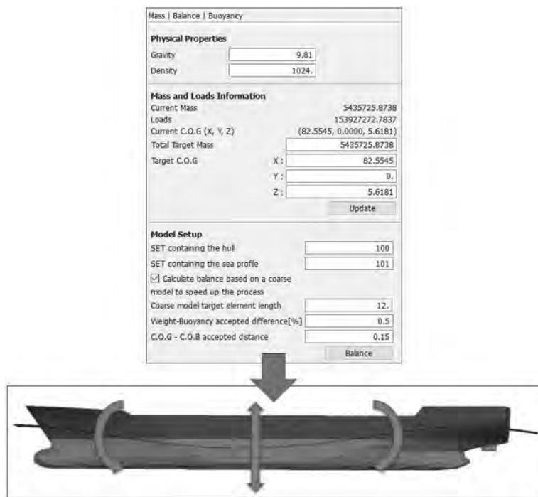
Рис. 4 – Корректировка положения судна
