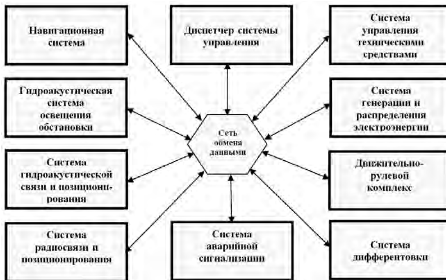
Рис. 1 – Структурная схема мультиагентной системы управления АНПА
