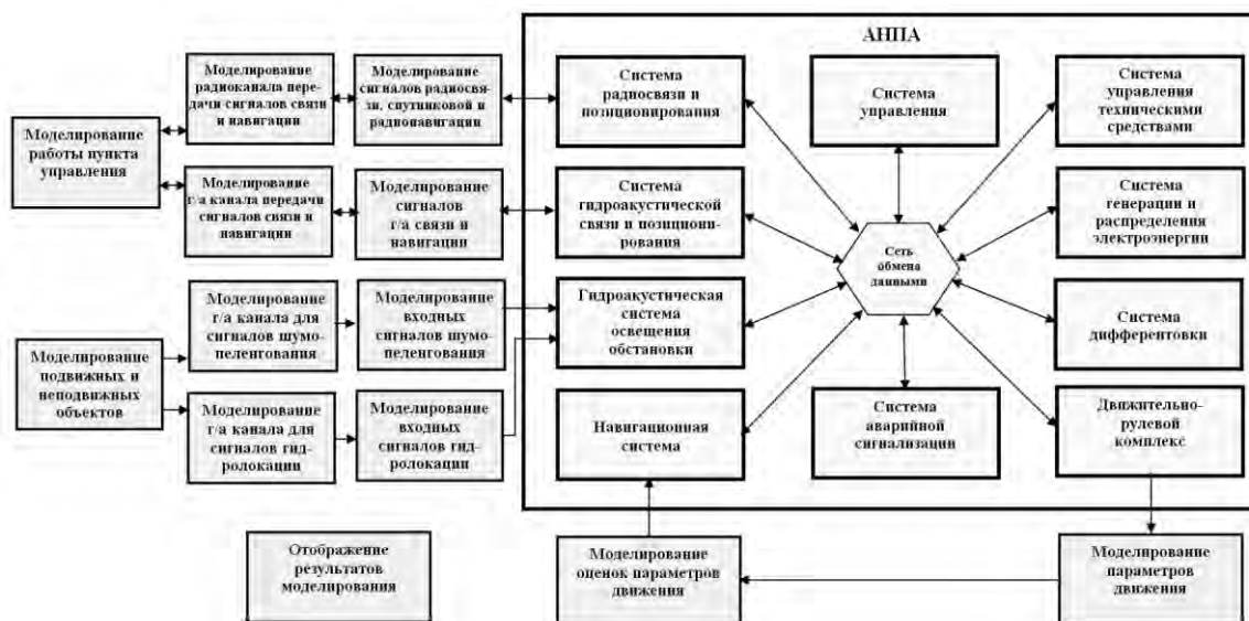
Рис. 2 – Структура программного обеспечения стенда моделирования алгоритмов управления АНПА
