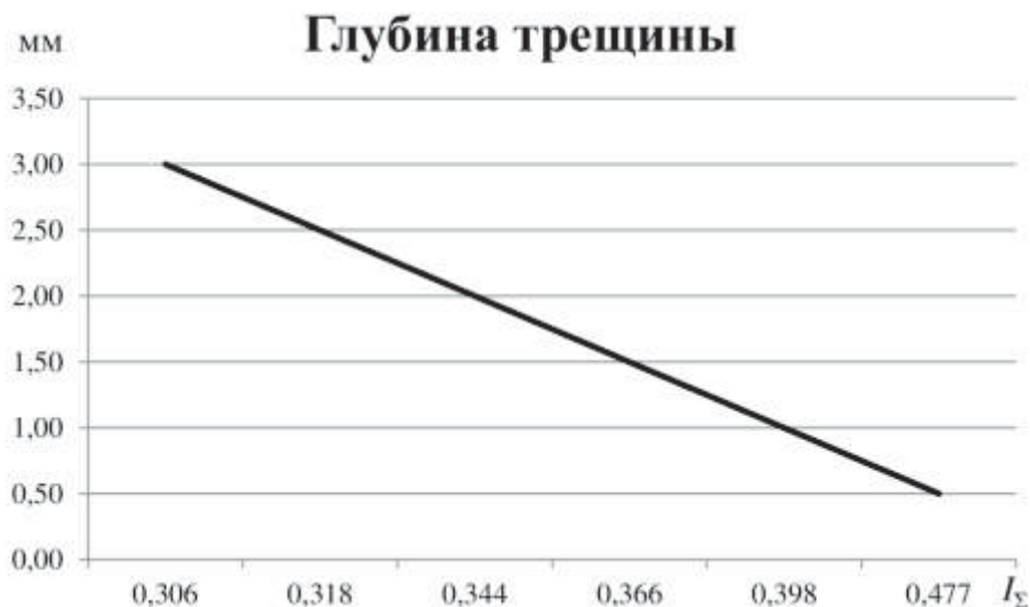
Рис. 3. Зависимость глубины трещины от суммарной интенсивности сигнала в моделируемом изображении
