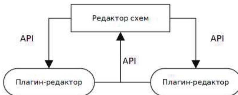
Рис. 3. Схема взаимодействия редактора схем и расширений
