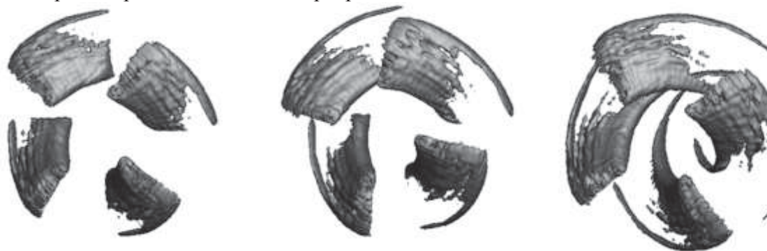
Рис. 7. Динамика изоповерхности завихренности
