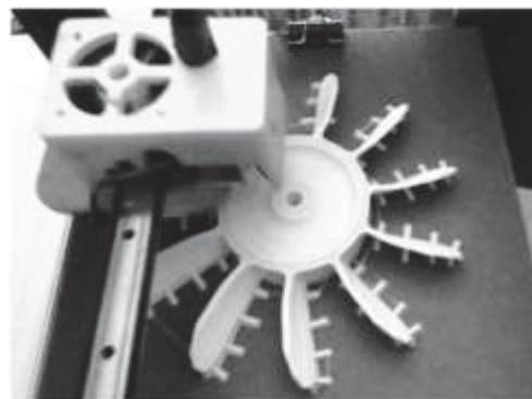
Рис. 6. Процесс печати опытной модели
