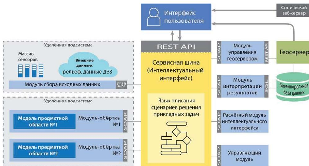
**Рис. 2. Обобщенная архитектура создаваемого экспериментального образца имитационно-моделирующего стенда**
