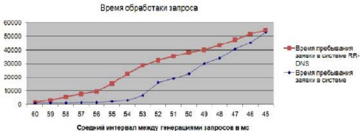
Рис. 2 График зависимости времени пребывания заявки в системе от интервала между поступлениями заявок в систему
