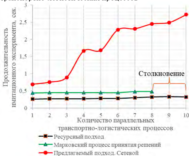
Рисунок 16 – Результаты сравнительного анализа подходов к моделированию оперативного управления в СИМ промышленного железнодорожного узла
