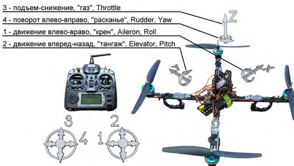
Рис. 2. Пример назначения стиков управления движением БПЛА
