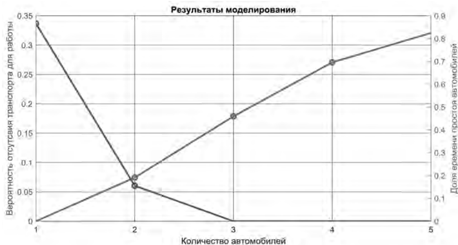
Рис. 4. Результаты моделирования простоев и отсутствия транспорта для выполнения производственных задач
