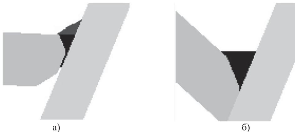
Рис. 3. Схема раскладки швов – всего три шва а) – два на лицевой стороне; б) – один на обратной
