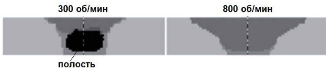
Рис. 13. Строение поперечного сечения шва при минимальном и максимальном значении \omega
