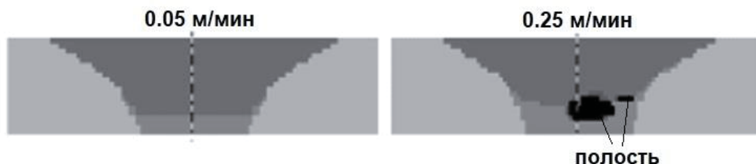
Рис. 19. Строение поперечного сечения шва при минимальном и максимальном значении v_w
