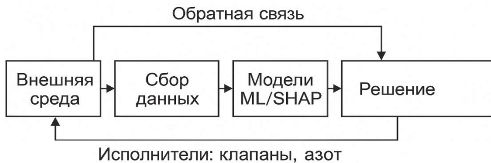
Рис. 4. Адаптивная структура системы управления
