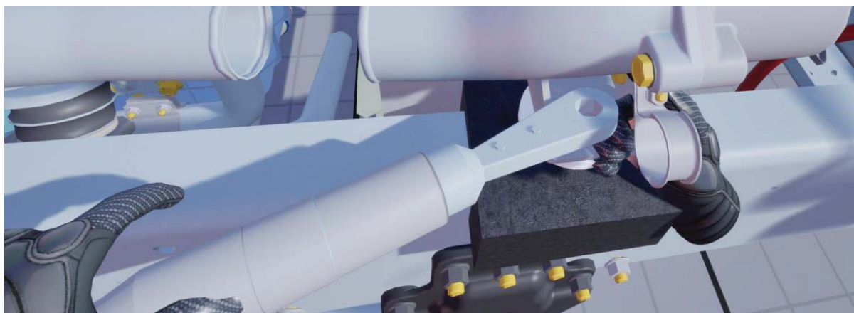
Рис. 2. Пример проверки эргономики и собираемости: позиционирование пневмогайковерта для затяжки крепления
