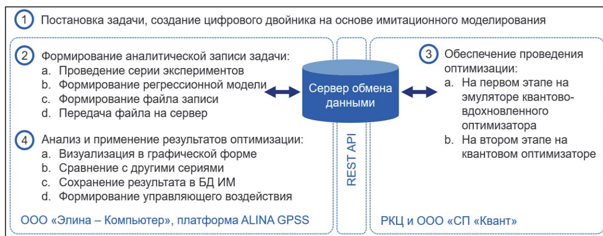
Рис. 11. Принципиальная схема оптимизации с использованием имитационного моделирования и квантово-вдохновленных алгоритмов
