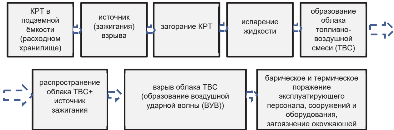
Рис. 2. Сценарий, приводящий к взрыву внутри помещений ОНКИ
