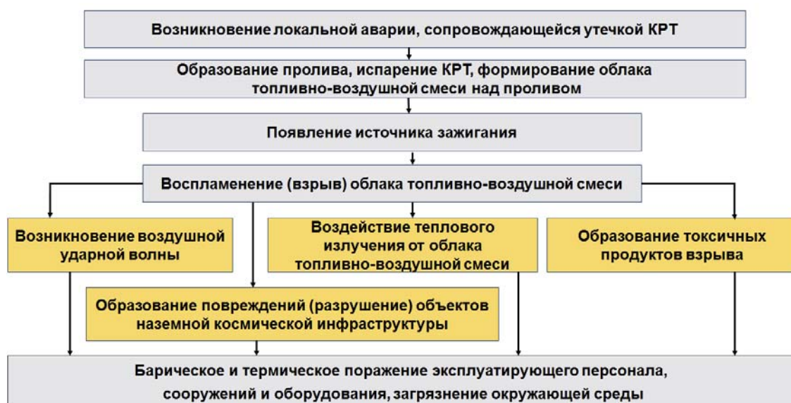
Рис. 4. Обобщённый сценарий взрыва компонентов ракетного топлива на объекте наземной космической инфраструктуры
