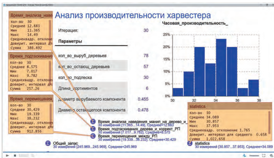
Рис. 2. Пример имитационного эксперимента работы харвестера в системе имитационного моделирования AnyLogic
