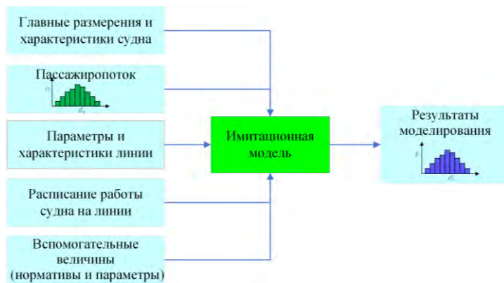
Рис. 3. Принципиальная блок-схема моделирования работы судна на линии
