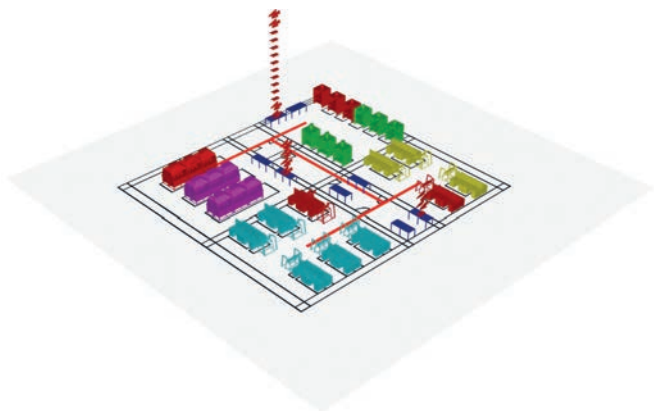
Рис. 5. Фрагмент механосборочного производства в системе моделирования. Красным цветом выделено оборудование, задействованное в изготовлении изделия «Кронштейн». Также красным цветом выделены пути/потоки изделий «Кронштейн». Снимок состояния производства, сделанный в процессе выполнения эксперимента (прогона модели). Источник: разработано авторами на основании собственных исследований
