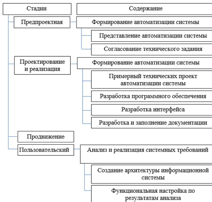
Рис. 1. Этапы проектирования и разработки имитационной модели
