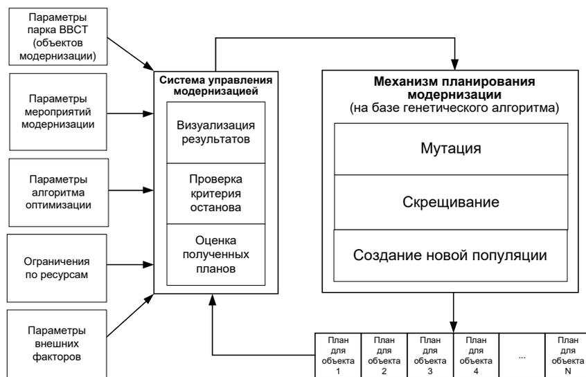
Рис. 3 – Обобщенная схема имитационной модели «Системы модернизации»
