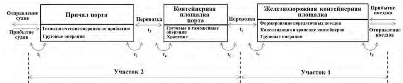
Рисунок 6 – Технологическая схема работы транспортного узла Пусан ( t_1 – время грузовых операций с судами; t_2 – время грузовых операций с внутритерминальным автотранспортом на причале порта; t_3 – продолжительность перемещения контейнеров внутритерминальным автотранспортом с грузового фронта причала на контейнерную площадку порта; t_4 – время грузовых операций с внутритерминальным автотранспортом на контейнерной площадке порта; t_5 – время грузовых операций на контейнерной площадке порта с внешними и внутритерминальными автомобилями; t_6 – продолжительность перевозки контейнеров внутритерминальными автомобилями с контейнерной площадки порта на железнодорожную контейнерную площадку; t_7 – время грузовых операций с внутритерминальным автотранспортом на железнодорожной контейнерной площадке; t_8 – время грузовых операций с железнодорожным подвижным составом (в программе единицей модельного времени является минута)
