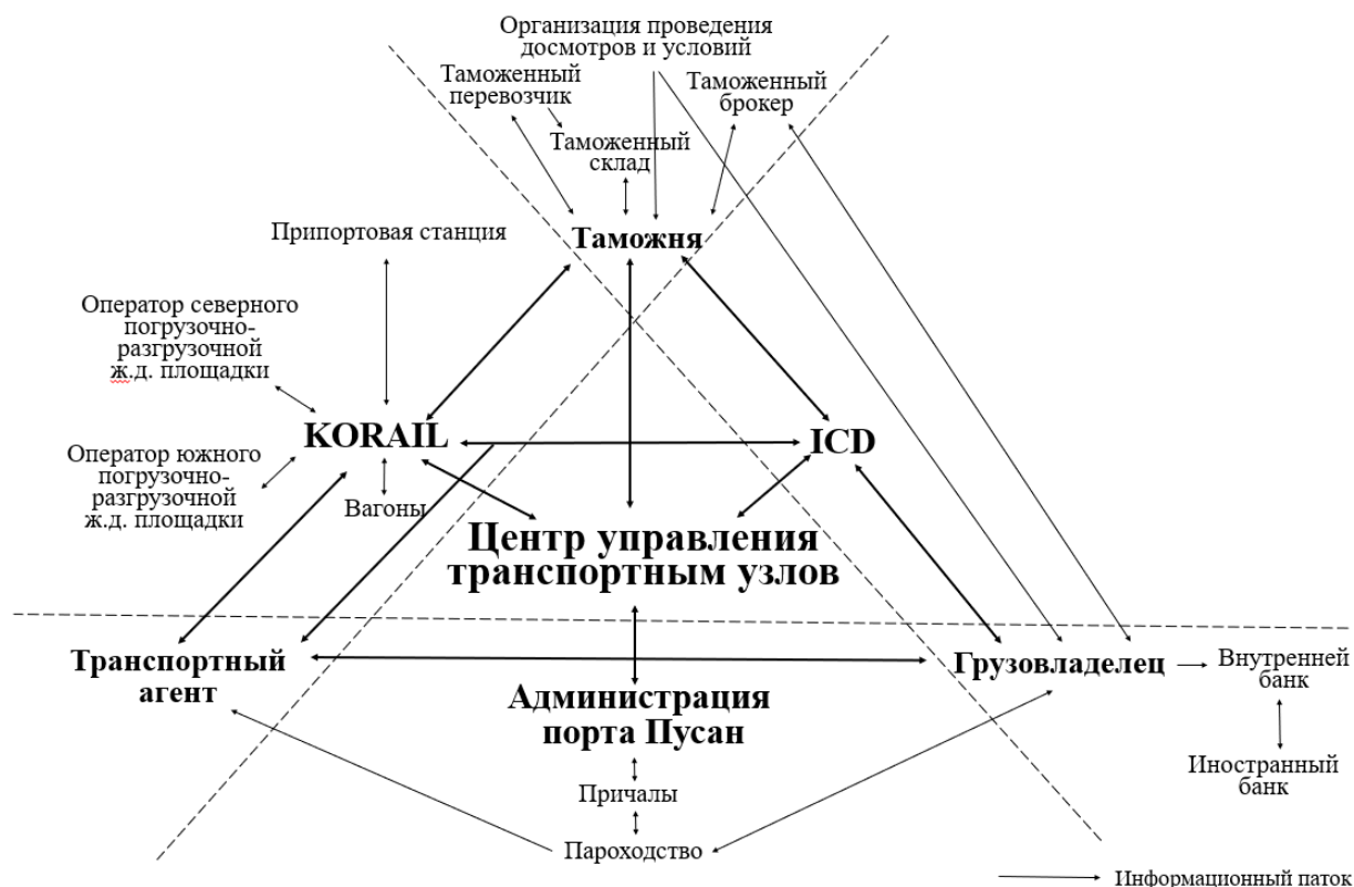
Рисунок 8 – Предлагаемая схема движения информационных потоков в транспортном узле Пусан с единым центром управления
