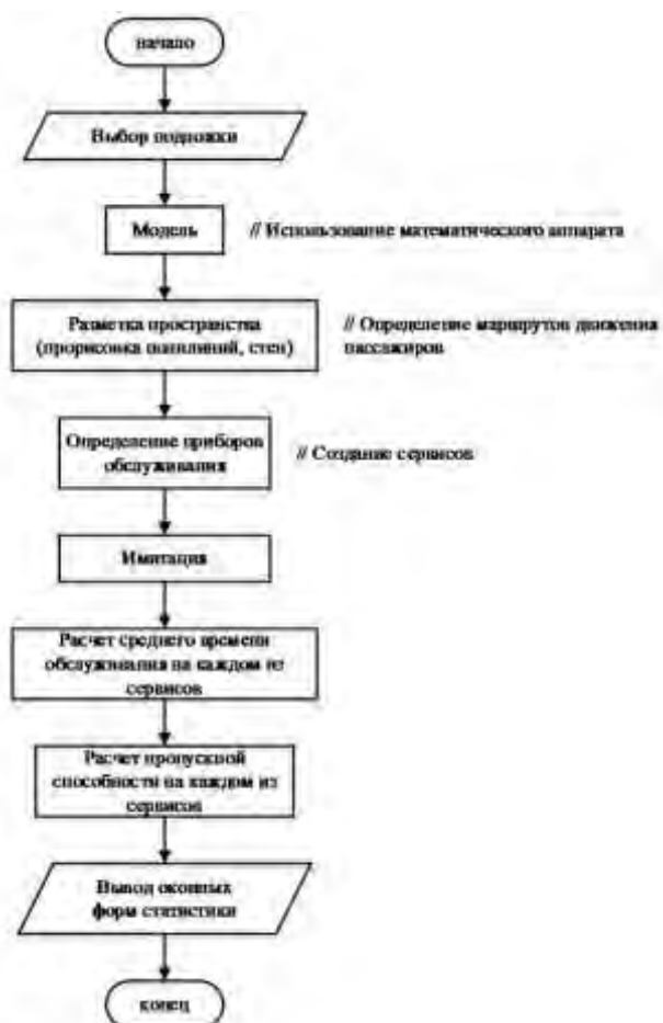
Рис. 3. Алгоритм работы модели цифрового двойника аэровокзального комплекса
