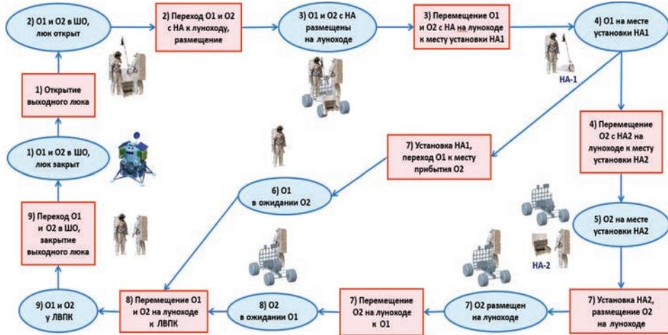
Рис. 1. Циклограмма ВКД в виде сети Петри
