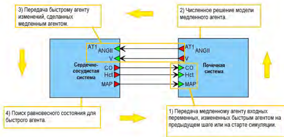
Рис. 1. Алгоритм симуляции агентной модели, демонстрирующей взаимодействие сердечно-сосудистой и почечной систем. Значения среднего артериального давления (MAP), сердечного выброса (CO) и гематокрита (Hct) передаются медленному агенту почечной системы. После того как этот агент сделает один шаг по времени, значения общего объема крови (V) и концентрации ангиотензина II, связанного с AT1-рецепторами (AT1_ANGII), сообщаются быстрому агенту сердечно-сосудистой подмодели. Далее осуществляется поиск равновесного состояния быстрого агента, после чего процесс повторяется.
