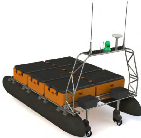
Рисунок 7 – Возможная компоновка катамарана для проведения натурных морских испытаний алгоритмов расхождения Figure 7 – Layout of a catamaran for full-scale sea testing of collision avoidance algorithms
