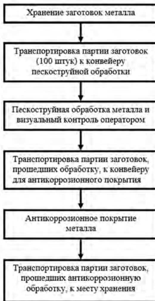
Рис. 6 Процесс пескоструйной обработки металла
