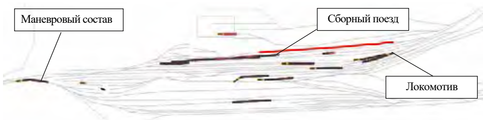
Рис. 7. Фрагмент представления схемы путевого развития в цифровом двойнике железнодорожного узла
