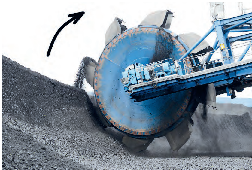
Рис. 5. Роторный ковш стакера-реклаймера в процессе забора угля со склада
