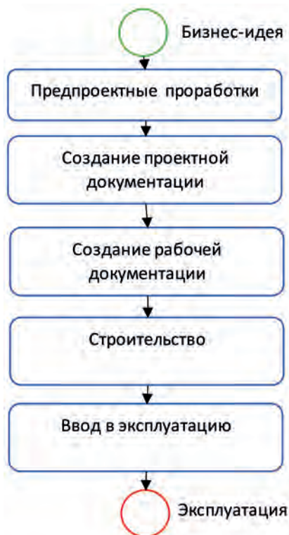
Рис. 1. Стадии создания контейнерного терминала
