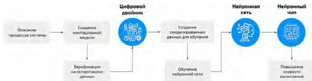
Рис. 6. Архитектура технологии «ИМ – нейронная сеть – нейрочип»
