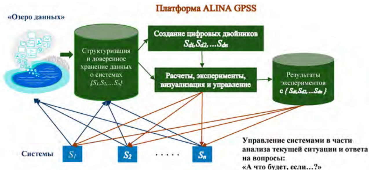
Рис. 3. Функциональная структура платформы ALINA GPSS
