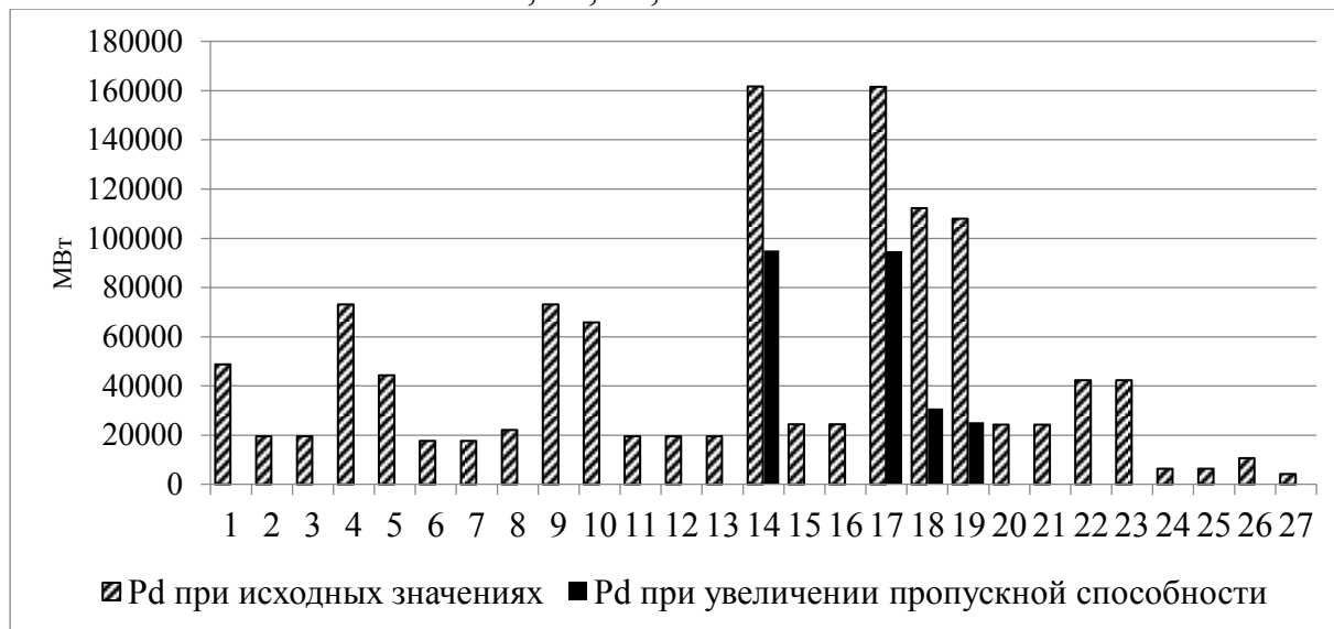
Рисунок 8 – Дефициты мощности из-за недостатка пропускных способностей сечений при оценке надежности (1-27 – связи)
