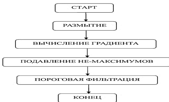
Рисунок 3.8 Описание алгоритма детектора Canny
