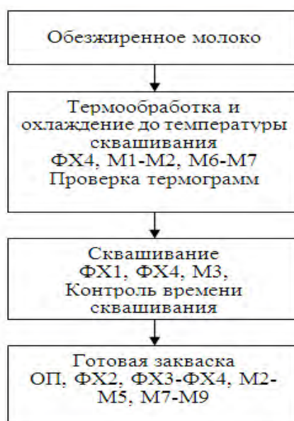
Рисунок 1.9 Схема точек контроля закваски
