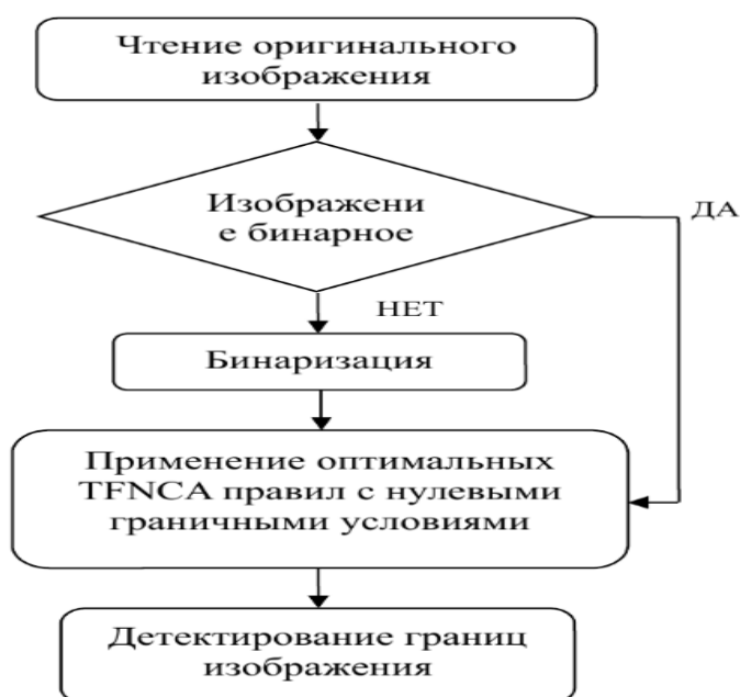
Рисунок 3.11 Потокоская схема алгоритма TFNCA
