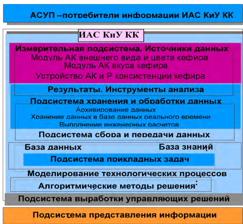
Рисунок 4.1. Структура интеллектуальной автоматизированной системы контроля и управления качеством кефира (ИАСКУКК)
