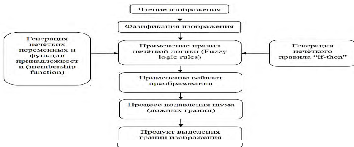
Рисунок 3.10 Принцип работы гибридного детектора границ
