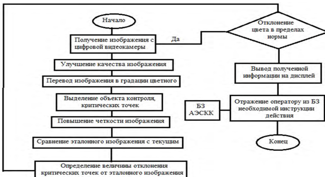
Рисунок 3.18. Блок - схема алгоритма принятия решения на соответствие внешнего вида и цвета кефира эталонному значению
