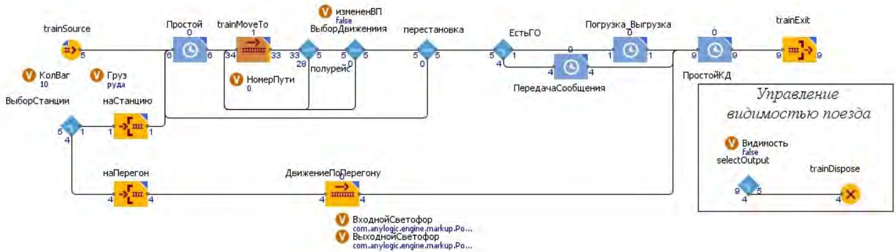
Рис. 6. Фрагмент потоковой диаграммы AnyLogic, имитирующей работу локомотиво-составительской бригады в агенте типа «Поезд»
